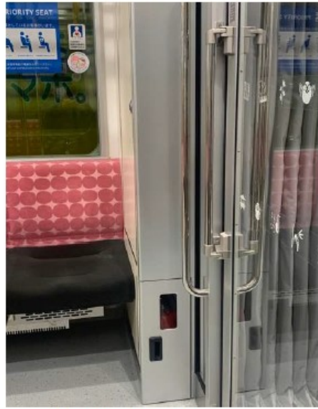
よく見ると消火器が入っている
